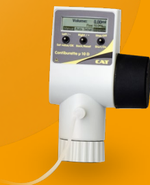
Automatischer Dispenser CAT Contibürette \mu 10D zum Dosieren von Flüssigkeiten
